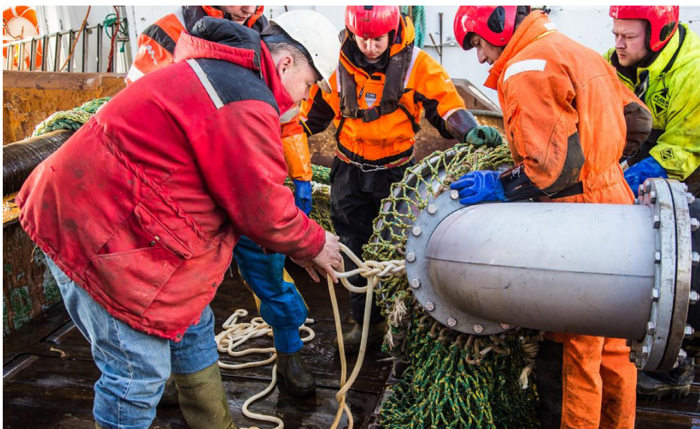
Figur 20 Festing av codend til pumpe­slangen (Foto: © NOFIMA)
