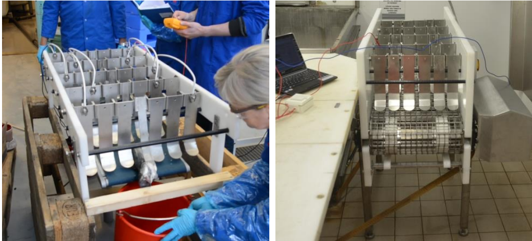
Figur 16 To kompakte versjoner av elektrobedøveren STANSAS #1. Til venstre: Elektrobedøveren koplet med (+) og (-) elektroder på annenhver rekke hvor transportbåndet ikke ledet strøm. Til høyre: Elektrobedøveren med transportbånd av stål (-) som fungerer som motelektrode til rekkene med elektroder (+). Foto; SINTEF Fiskeri og havbruk
