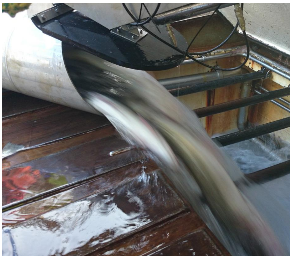
Figur 21 Vakuumpumpen leverte 20 tonn per time og fisken ble pumpet ned i mottaksbingene (Foto: © NOFIMA)
